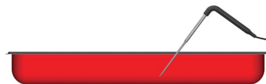
2A. Innstikksføleren bør plasseres i midten av varen for at kjernetemperaturen skal bli som innstilt.
